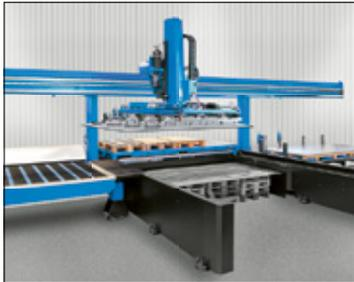
(3) Transport von Blech zur Maschine
