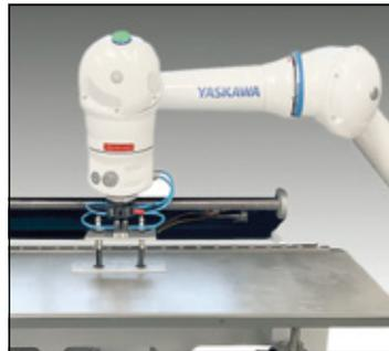
(2) Entladen mit Sortierung durch Cobot
