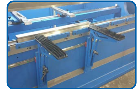
Vorderanschlüge mit Bürsten Oberfläche, verschiebbare auf Linearführung und in der Höhe verstellbar.
