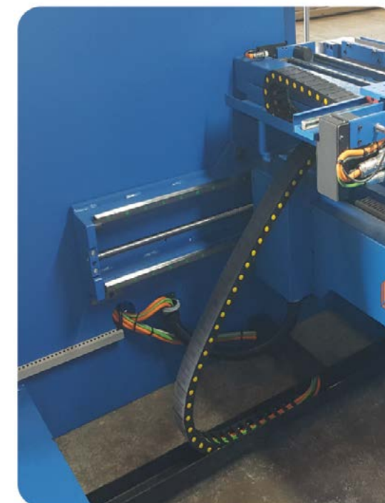
Hinteranschlag mit doppelten Linearführungen und verschleißfreien, bürstenlosen Antrieben.
