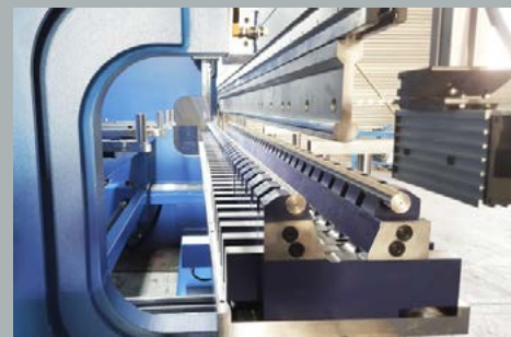
Sonderwerkzeug: Einstellbare Matrize, V=25 - 400mm.
