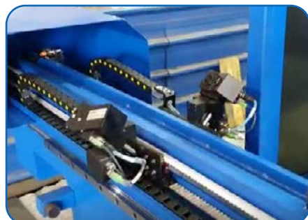
i-measure System: Automatisierte Messung und Korrektur der Biegewinkel mit Lasersensoren (Option)
