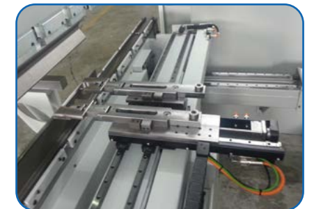
5-Achsen Hinteranschlagsystem, X-X'-R-Z1-Z2 mit Funktion Delta-X inklusive (Option)
