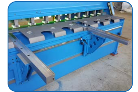
Verschiebbare Vorderanschlüge auf Linearführung (Option).
