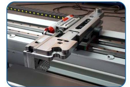
Automatische Blechstärkenmessung zur Übergabe an die Steuerung (Option)
