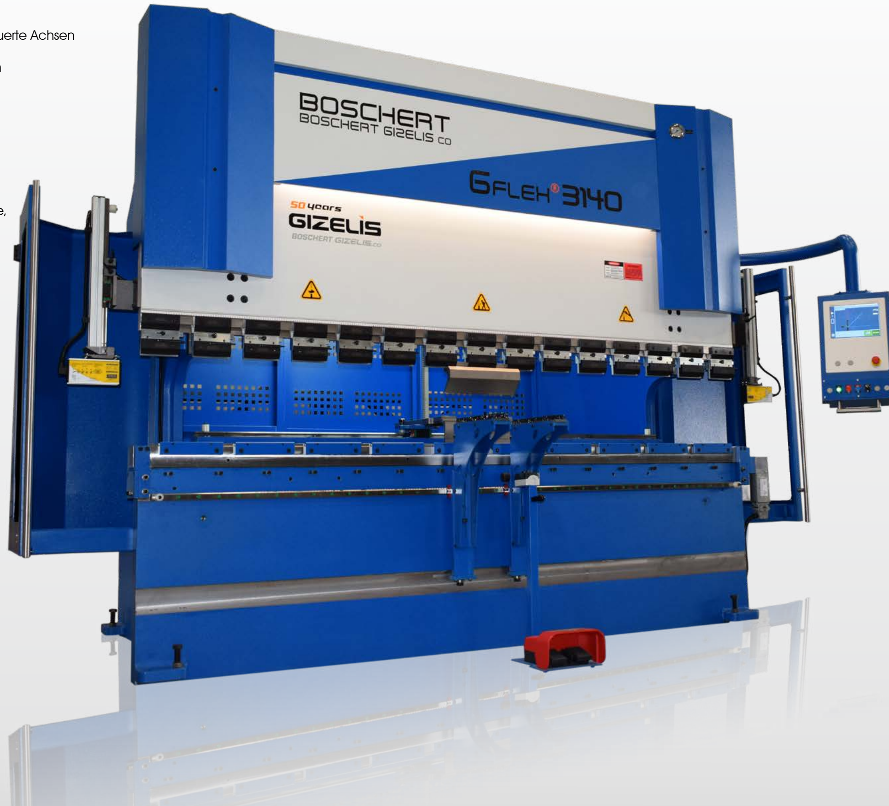
Industrielle 2D Steuerung, 15" Farb-Touchscreen, CybTouch15, einschließlich Touch-Profil-Funktion und automatische Biegefolge Berechnung.
