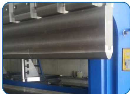
Schwerlastklemmsystem bis 350t/m (Option)
