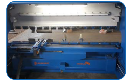
Freier Raum auf der Maschinenrückseite durch Positionierung der Anschlagführung auf der Innenseite des Maschinengestelles
