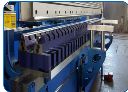
Verstellbare Matrize, CNC oder manuelle Einstellung (Option)
