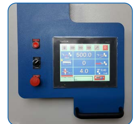
10.4" Touch-Screen Steuerung auf Linearführung verschiebarr (option).
