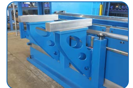
CNC Vorderanschlag (Biegehilfe), automatische Höheneinstellung (Option)
