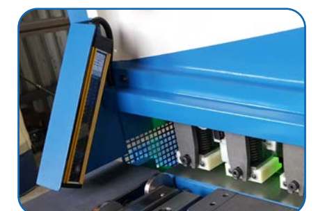
Fingerschutz durch Lichtschrank (Option).
