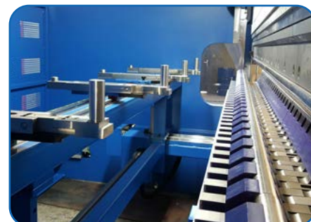
Sondere Anschlagfinger für dicke Bleche (Option)
