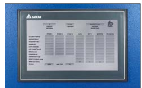
Touch Bildschirm zur Eingabe der BLS ( BOSCHERT Laser System) Parameter des Laser
