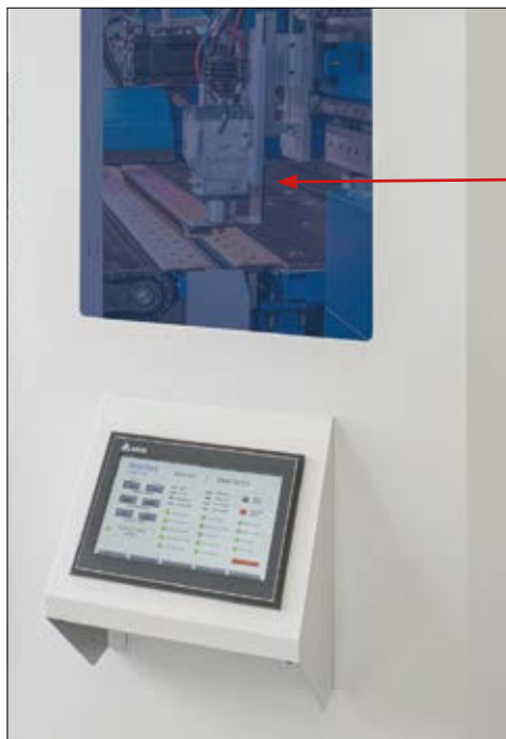
Touch Bildschirm zur Eingabe der BLS ( BOSCHERT Laser System) Parameter des Laser
