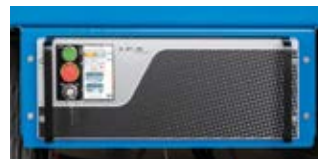
Clever integrierte IPG Faserlasersource ; 1, 2, 3, oder 4kW Leistung
