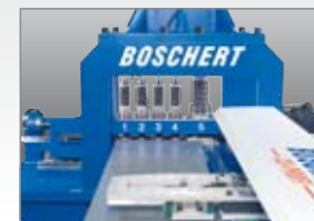
Côté évacuation pièces avec table basculante.
