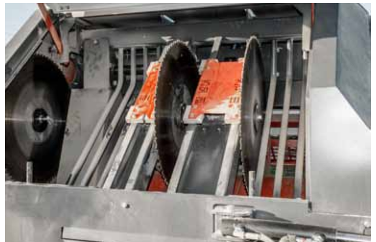
Der Wechsel der Schnittlängen geschieht durch Umschrauben der Sägeblätter. Hier die Einstellung für 33er-Scheite. Das dritte Blatt links in der Parkposition wird erst bei der Schnittlänge 25 cm benötigt.
