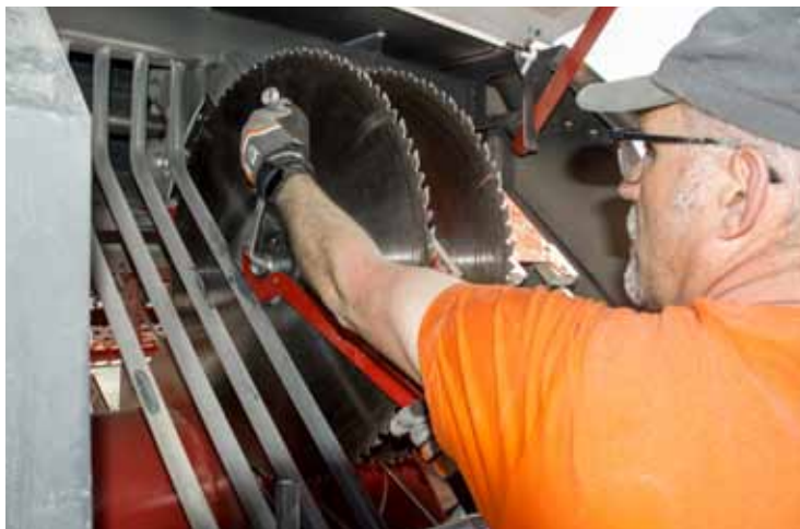
Der Blattwechsel geht schnell von der Hand. Der Spezialschlüssel zum Blockieren der Achse sowie der Schraubenschlüssel finden sich in einer kleinen Schublade an der Maschine.
